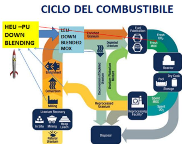
Fig.6 - Inserimento del materiale fissile proveniente dalle testate atomiche
