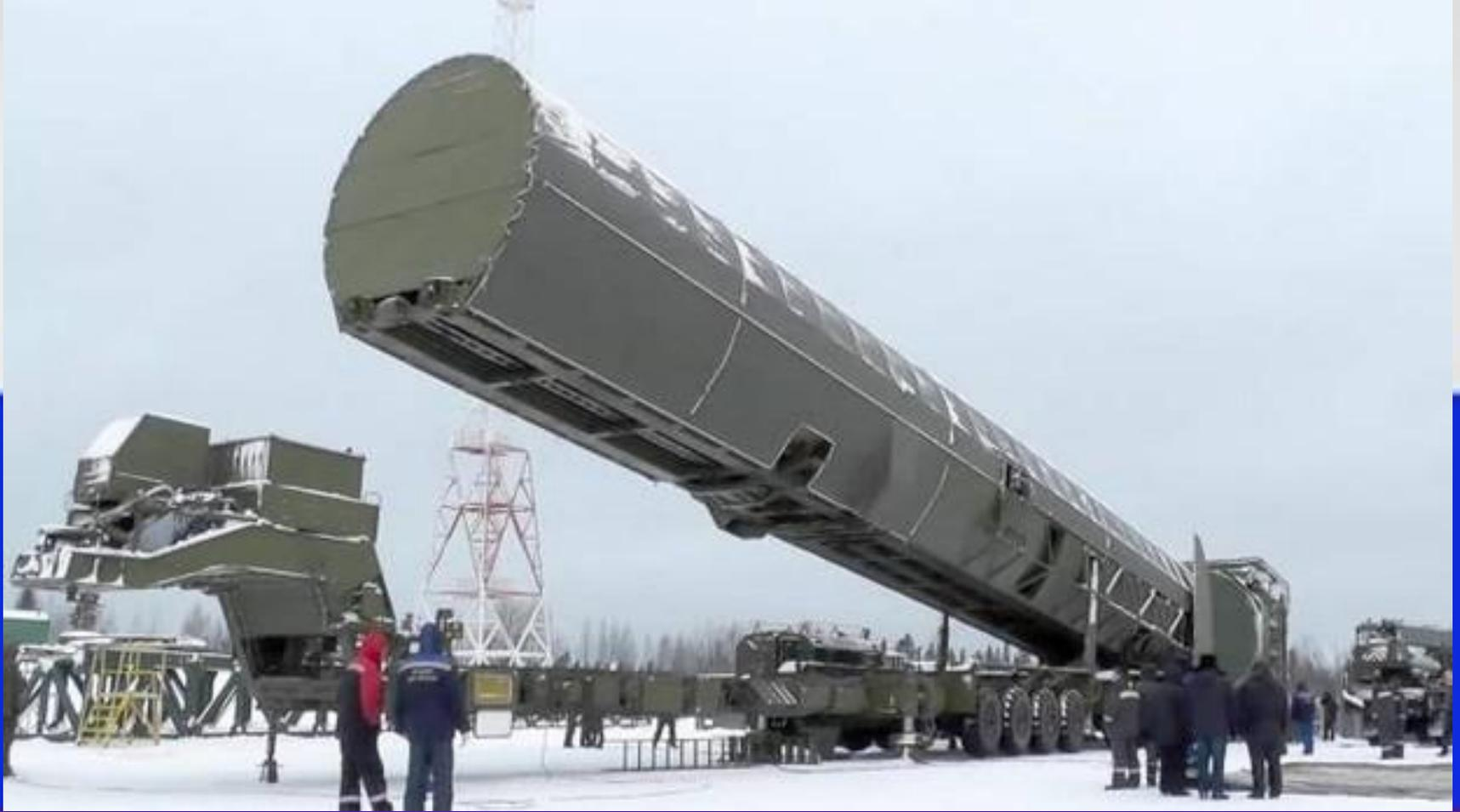
**Il Sarmat Rs28** pesa 200 tonnellate, è un missile a due stadi con un carico utile di 10 tonnellate e una gittata di 11mila chilometri, è in grado di trasportare fino a 15 testate nucleari. E' dotato di diversi dispositivi elettronici come i falsi bersagli per ingannare i sistemi anti missilistici. In volo può variare rotta e velocità, rendendosi quasi impossibile da intercettare
